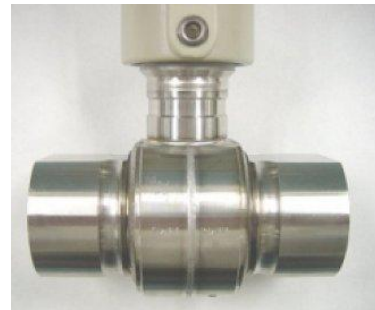
Figura 31: Cuerpo de medida soldado para la solución de sello remoto completamente soldada Cuerpo de medida soldado para la solución de sello remoto completamente soldada. El cuerpo de medida ST 800 soldado es una parte importante de la solución de sello remoto completamente soldada, que normalmente se utilice en las aplicaciones de vacío.
