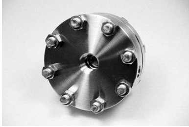
Figura 25: Sellos con conexiones del proceso roscadas Los sellos con conexiones del proceso roscadas se pueden utilizar con transmisores de presión absoluta, presión diferencial y presión manométrica y están disponibles con conexiones del proceso hembra de NPT de \frac{1}{2} ", \frac{3}{4} " y 1".
