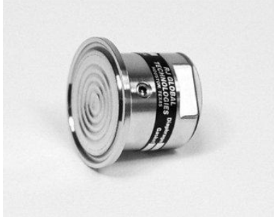
Figura 26: Sellos sanitarios Los sellos sanitarios se pueden utilizar con transmisores de presión absoluta, presión diferencial y presión manométrica y están disponibles con conexiones del proceso Tri-Clover y Tri-Clamp de 3" y 4".
